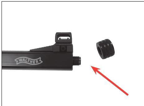
Pour fixer le silencieux, l'écrou du canon doit tout d'abord être retiré.
