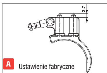
Podczas dostawy spust jest ustawiony standardowo (ilustracja A). Należy przestawiać zawsze tylko jedną śrubę i przetestować funkcję i działanie. Wkręcanie śruby powoduje zmniejszenie siły i dróg. Wykręcanie powoduje wydłużenie dróg i zwiększenie sił zwalniania spustu.
