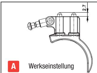
Im Auslieferungszustand ist der Abzug, standartmäßig eingestellt (Bild A). Verstellen Sie immer nur eine Schraube und testen Sie die Funktion und Auswirkung. Durch eindrehen der Schraube verringen sich Kraft und Wege. Durch herausdrehen verlängern sich Wege und erhöhen sich die Abzugskräfte.
