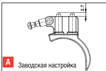
В состоянии поставки спусковой крючок имеет стандартную настройку (рис. А). Изменяйте настройку только с помощью одного винта и проверяйте работу и результат. При вворачивании винта усилие и путь уменьшаются. При выворачивании удлиняется путь и увеличивается усилие спуска.
