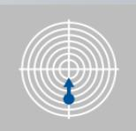
Bewegung des mittleren Schusspunktes **nach oben** – den Knopf der Höheneinstellung in Pfeilrichtung „UP“ drehen.
