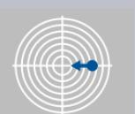
Bewegung des mittleren Treppunktes **nach links** – den Knopf der horizontalen Einstellung gegen die Richtung des Pfeils „R“ drehen.
