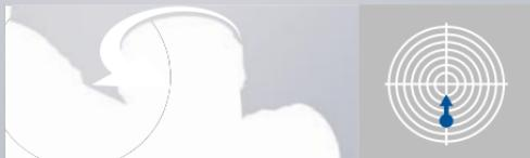
Per spostare il punto di mira centrale **verso l'alto** ruotare la torretta di regolazione verticale nella direzione della freccia "UP" (SU).
