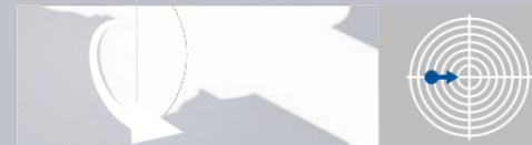
pohyb středního bodu zásahu **doprava** – otočte ovladačem točítka stranové korekce ve směru šipky „R“
