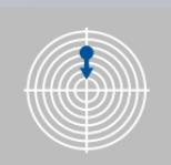
Bewegung des mittleren Treppunktes **nach unten** – den Knopf der vertikalen Einstellung gegen Pfeilrichtung „UP“ drehen.
