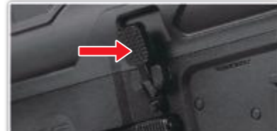
ボルトリリースレバーを押して、ボルトキャッチを解放します。
