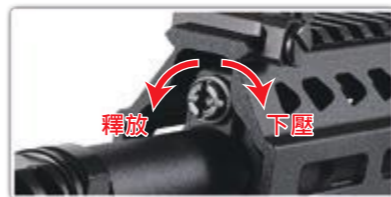
旋轉調整上旋器的下壓及釋放功能。
