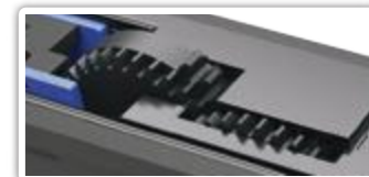
Esta imagen muestra la posición correcta del engranaje de sector después del reinicio.
