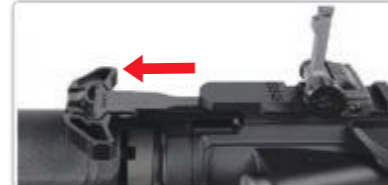
Halando la manija de carga llevará el cerrojo atrás y abrirá la cubierta.
