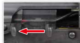
Tirer le levier de culasse vers l'arrière.
