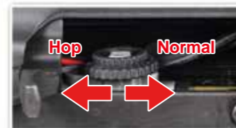
Tournez la molette de réglage pour ajuster le hop-up.
