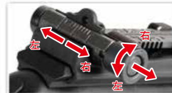
拉出並順時針旋轉照門側邊的調整鈕移動視孔至右方。 拉出並逆時針旋轉照門側邊的調整鈕移動視孔至左方。
