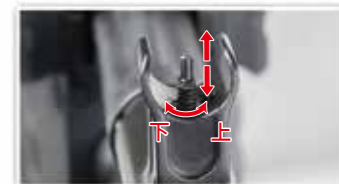
使用尖嘴鉗旋轉調整星尖的高度。
