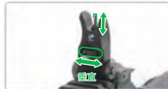
垂直調整鈕(上/下調整瞻孔)
