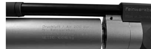
Pressluftbehälter gelöst Compressed air cylinder loosened
