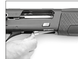
Вставьте патрон в нижнюю часть ствольной коробки и полностью задвиньте его в переднюю часть магазина.
