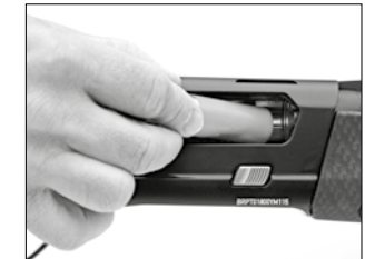
Вставьте патрон через выбрасыватель в затворе
