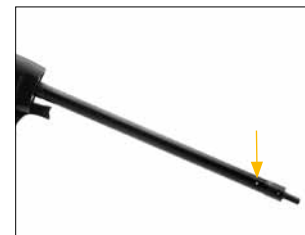
Coloque algunas gotas de aceite en la abertura del tubo de la acción.
