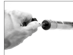
Utilizzare una chiave o un piccolo cacciavite per esercitare pressione sull'adattatore a tre colpi, quindi ruotare di un quarto di giro.
