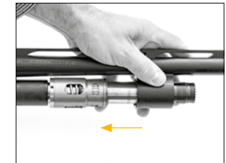
Задвиньте ствол и поршень на трубчатый магазин и хвостовик ствола в ствольную коробку
