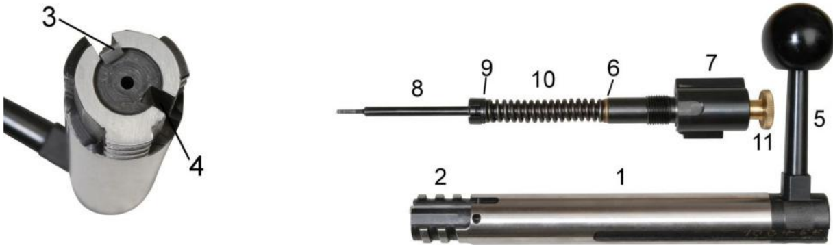
Bild 2: Verschluss bis Kal. 223 Rem
