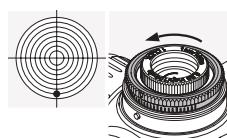
Ruotate l'anello zigrinato esterno sulla torretta superiore in direzione dell'H (senso antiorario).
