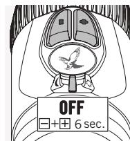
Sie können die SWAROLIGHT Funktion deaktivieren. Drehen Sie hierzu den AUS/TAG/NACHT-Schalter in die Mittelstellung und drücken dann die +/- Tasten gleichzeitig für 6 Sekunden. Ein zweimaliges Blinken des Leuchtpunktes bestätigt die Umschaltung. Durch ein Wiederholen dieses Schrittes aktivieren Sie die SWAROLIGHT Funktion erneut.
