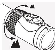
La anilla de ajuste de aumentos tiene un rango de giro de 180° para obtener el aumento deseado. El ajuste es continuo. La escala de la anilla de ajuste permite conocer en todo momento el nivel de aumento. La suave superficie ranurada de la anilla de ajuste tiene una pestaña que facilita identificar el punto de aumento en el que se encuentra.
