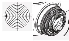
Ruotate l'anello zigrinato esterno sulla torretta laterale in direzione della R (senso antiorario).
