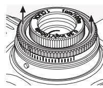
1. Heben Sie den äußeren Rändelring an, der in dieser Stellung gehalten und dann entsprechend gedreht werden muss. Er bleibt nicht selbstständig in dieser angehobenen Position.
