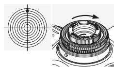
Drehen Sie den äußeren Rändelring der Höhenverstellung entgegen der Pfeilrichtung H – im Uhrzeigersinn.
