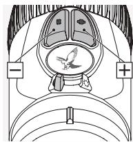
Затем с использованием кнопок  $+$ / $-$  можно настроить яркость для выбранного режима. Для быстрого получения идеального уровня яркости можно нажать и удерживать одну из кнопок (длинный импульс). Для выполнения точной настройки используйте однократное нажатие кнопок (одиночный импульс).
