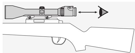
Ställ in korrekt ögonsavstånd för kikarsikten som monteras på vapen (måttet hittar du i det tekniska databladet).
