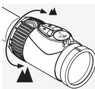
Ruotate l'anello di regolazione dell'ingrandimento di 180° per ottenere l'ingrandimento che desiderate. La regolazione avverrà di conseguenza. La scala sull'anello di regolazione consente una comoda visione delle impostazioni. Al fine di facilitarne l'orientamento, il morbido rivestimento scanalato dell'anello di regolazione presenta una piccola sporgenza.
