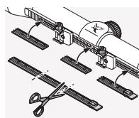
La protection fournie permet de protéger les parties exposées du rail de montage. Vous pouvez la couper aux dimensions souhaitées ; insérez-la dans le rail avec vos doigts.
