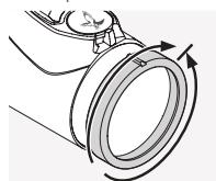
Draai de dioptiestelring eerst helemaal naar links (tegen de klok in) en vervolgens naar rechts, tot het dradenkruis de optimale scherpte heeft. Het correctiebereik is afhankelijk van het specifieke model. Meer informatie hierover vind je op het bijgevoegde technische gegevensblad.
