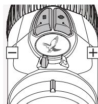
Ahora puede ajustar la luminosidad en el modo que haya seleccionado utilizando los botones +/- . Para lograr rápidamente el nivel ideal de luminosidad, puede pulsar y mantener pulsado uno de los botones (pulsación larga). Para realizar ajustes precisos, presione cualquiera de los botones una vez (pulsación única).
