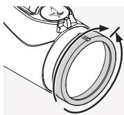
Ruotate prima l'anello di compensazione diottrica completamente verso sinistra (in senso antiorario) e poi verso destra, fino a raggiungere la nitidezza massima del reticolo.
