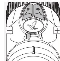
Du kan nu reglera ljusstyrkan i det valda läget med hjälp av knapparna + och -. För att snabbt hitta rätt ljusstyrka kan du hålla aktuell knapp tryckt (lång puls). Om du vill finjustera trycker du en gång på knappen (enstaka puls).
