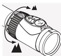
Haluttu suurennus saadaan käänämällä suurenヌksen säätörengasta korkeintaan 180 astetta. Säätö on portaaton. Säätörenkaan asteikko helpottaa asetuksen hahmottamista.
