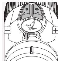
Vous pouvez maintenant régler le niveau de luminosité du mode sélectionné à l'aide des boutons +/- . Pour atteindre rapidement le niveau de luminosité idéal, appuyez longuement sur l'un des boutons et maintenez-le enfoncé. Pour effectuer des réglages précis, appuyez une fois brièvement sur l'un ou l'autre des boutons.
