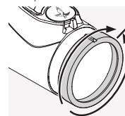
D'abord, tournez la bague d'ajustement dioptrique entièrement vers la gauche (sens inverse des aiguilles d'une montre), puis vers la droite, jusqu'à ce que la mise au point du réticule
