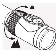
Drej indstillingsringen til forstørrelse helt op til 180° for at opnå den ønskede forstørrelse. Indstillingen foretages løbende. Skalaen på indstillingsringen gør det nemt at aflæse indstillingen. Det bløde, riflede overtræk på indstillingsringen har et lille fremspring for at lette orienteringen.
