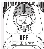
Puede desactivar la función SWAROLIGHT llevando el interruptor DESACTIVADO/DÍA/NOCHE a la posición central y pulsando los botones +/- simultáneamente durante 6 segundos. La luz parpadeará dos veces para confirmar que se desactiva la función. Puede volver a activar SWAROLIGHT repitiendo este paso.
