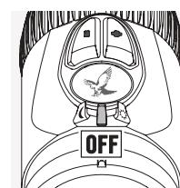
Drehen Sie hierzu den AUS/TAG/NACHT-Schalter in die Mittelstellung.
