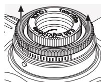
1. Levante la anilla ranurada exterior y manténgala levantada mientras la gira. No permanecerá levantada por sí misma. Cuando gire la anilla ranurada en esta posición, no se ajustará la retícula.
