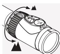
Draai de vergrotingsstelring tot maximaal 180° om de gewenste vergroting traploos in te stellen. De schaal op de stelring maakt een eenvoudig aflezen van de instelling mogelijk. Voor een betere oriëntering heeft de licht geprofileerde stelringomhulling een neusje.
