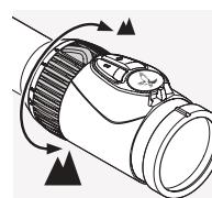
Genom att vrida förstoringsinställningsringen upp till 180° kan du ställa in önskad förstoring. Inställningen är steglös. Skalan på inställningsringen gör det enkelt att avläsa inställningen. Det mjuka, räfflade skyddet har en liten utskjutande del som gör det lättare att orientera sig.
