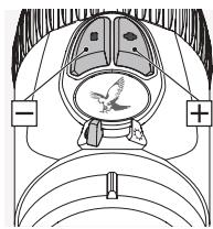
Una volta selezionata questa modalità, potete regolare la luminosità grazie ai tasti +/-.. Per ottenere rapidamente il livello ideale di luminosità, tenete premuto uno dei tasti (impulso prolungato). Per regolazioni di precisione, premete i tasti una volta (impulso singolo).
