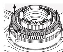
1. Soulevez la bague moletée extérieure et maintenez-la dans cette position pendant que vous la tournez. La bague moletée ne reste pas seule en position relevée ; dans cette position, elle ne permet pas de régler le réticule.
