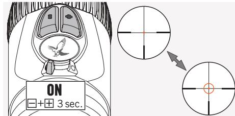
Drej kontakten FRA/DAG/NAT til positionen DAG eller NAT for at tænde for den oplyste ring på FLEXCHANGE 4A-IF sightet. Sigtbelysningen er nu aktiveret. Tryk på knapperne +/- samtidigt i tre sekunder for at tænde for den oplyste ring. Gentag dette trin for at slukke for ringen igen.
