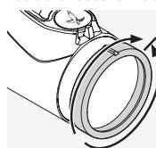
Primero, gire la anilla de ajuste de dioptrías completamente hacia la izquierda (sentido anti horario) y, posteriormente, gírela hacia la derecha hasta que vea la retícula nítida y enfocada. El rango de ajuste depende de cada modelo. Consulte las especificaciones técnicas adjuntas para obtener más información.
