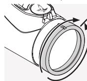
Drehen Sie erst den Dioptriestellring ganz nach links (gegen den Uhrzeigersinn) und dann nach rechts, bis das Absehen die optimale Schärfe zeigt. Die Stellbereiche sind von den einzelnen Modellen abhängig. Bitte lesen Sie hierzu im beigefügten technischen Datenblatt.
