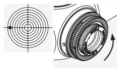
Drehen Sie den äußeren Rändelring der Seitenverstellung in Pfeilrichtung R – gegen den Uhrzeigersinn.
