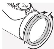
Käännä ensin silmäkohtainen säätörengas täysin vasemmalle (vastapäivään) ja sitten oikealle, kunnes ristikko on täysin tarkentunut. Säätövara vaihtelee malleittain. Lisätietoja on tuotteen teknisissä tiedoissa.
