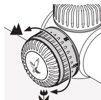
Med parallaksetårnnet kan du indstille skarpheden for enhver afstand til byttet og forhindre sigtefejl på grund af parallakse.
