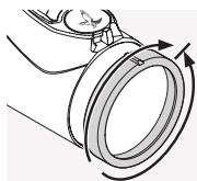
Сначала поверните кольцо диоптрической настройки влево (против часовой стрелки) до упора, а затем поворачивайте вправо, пока при цельная марка не будет в резком фокусе.
