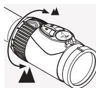
Durch Drehen des Vergrößerungsstellrings um bis zu 180° können Sie die gewünschte Vergrößerung stufenlos einstellen. Die Skala am Stellring ermöglicht ein einfaches und komfortables Ablesen der Einstellung. Zur besseren Orientierung besitzt der weiche, gerippte Stellringüberzug eine Nase.
