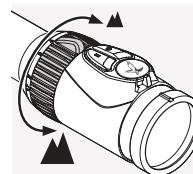
Tournez la bague de réglage du grossissement sur 180°, jusqu'à obtenir le grossissement souhaité. Le réglage est continu. Les graduations présentes sur la bague de réglage permettent de visualiser facilement le réglage. Le revêtement rainuré souple de la bague de réglage comporte une petite protubérance destinée à faciliter l'orientation.
