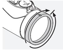
Ruotate prima l'anello di compensazione diottrica completamente verso sinistra (in senso antiorario) e poi verso destra, fino a raggiungere la nitidezza massima del reticolo.
