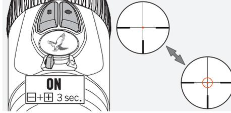
Kytke FLEXCHANGE 4A4F -ristikon valaistu rengas käyttöön kääntämällä POIS/PÄIVÄ/YÖ-kytkin PÄIVÄ- tai YÖ-asentoon. Ristikon valaistus on nyt aktivoitu. Kytke valaistu rengas käyttöön painamalla painikkeita +/- samaan aikaan kolmen sekunnin ajan. Kytke rengas pois käytöstä toistamalla tämä vaihe.
