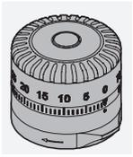
Det flexibla ballistiktornet (BTF) som kan konfigureras individuellt gör att du kan behålla siktet mitt i prick på önskat avstånd. Om du använder det som topporn kan det kompensera för en fallande kulbana. När det används som sidotorn är det optimalt vid justering för avdrift eller för uppskattning av framförhållningen. Det flexibla ballistiktornet kan monteras utan verktyg och är kompatibelt med alla tillgängliga riktmedel.
