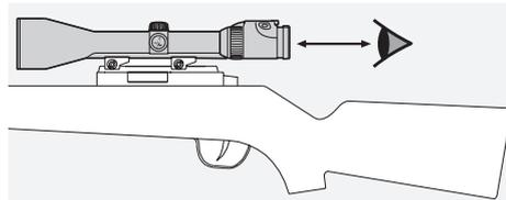
Ajuste la distancia ocular adecuadamente una vez que haya montado el visor sobre un arma (consulte las especificaciones técnicas adjuntas para conocer las medidas exactas).
