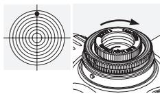
Vrid den yttre räfflade ringen på topptornet i motsatt riktning mot H (dvs. medsols).
