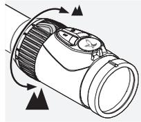
Ruotate l'anello di regolazione dell'ingrandimento di 180° per ottenere l'ingrandimento che desiderate. La regolazione avverrà di conseguenza. La scala sull'anello di regolazione
