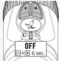
Sie können die SWAROLIGHT Funktion deaktivieren. Drehen Sie hierzu den AUS/TAG/NACHT-Schalter in die Mittelstellung und drücken dann die +/- Tasten gleichzeitig für 6 Sekunden. Ein zweimaliges
