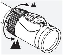
La anilla de ajuste de aumentos tiene un rango de giro de 180° para obtener el aumento deseado. El ajuste es continuo. La escala de la anilla de ajuste permite conocer en todo momento el nivel de aumento. La suave superficie ranurada de la anilla de ajuste tiene una pestaña que facilita identificar el punto de aumento en el que se encuentra. En función del modelo, la anilla de ajuste de aumentos incorpora una marca con 1x aumento (CLICKONE) para indicarle que está accediendo a la zona VIEWPLUS.
