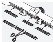
La protection fournie permet de protéger les parties exposées du rail de montage. Vous pouvez la couper aux dimensions souhaitées ; insérez-la dans le rail avec vos doigts.
