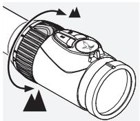
Durch Drehen des Vergrößerungsstellrings um bis zu 180° können Sie die gewünschte Vergrößerung stufenlos einstellen. Die Skala am Stellring ermöglicht ein einfaches und komfortables Ablesen der Einstellung. Zur besseren Orientierung besitzt der weiche, gerippte Stellringüberzug eine Nase. Modellabhängig bietet Ihnen der Vergrößerungsstellung eine Rastung bei 1facher Vergrößerung (CLICKONE), die Sie darauf aufmerksam macht, dass Sie in den VIEWPLUS Bereich gehen.
