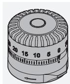
Det fleksible ballistiktårn (BTF) kan konfigureres separat og giver dig mulighed for at holde øjnene på byttet ved de ønskede afstande. Hvis det bruges som toptårn, kan det kompensere for kuglefald. Hvis det bruges som sidetårn, er det bedst egnet til vindjustering eller vurdering af
