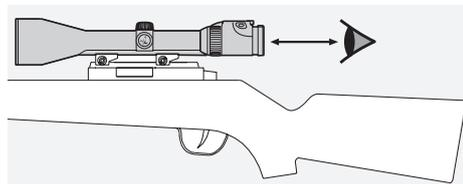
Ställ in korrekt ögonsavstånd för kikarsikten som monteras på vapen (måttan hittar du i det tekniska databladet).
