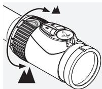
Drej indstillingsringen til forstørrelse helt op til 180° for at opnå den ønskede forstørrelse. Indstillingen foretages løbende. Skalaen på indstillingsringen gør det nemt at aflæse indstillingen.
