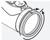
Сначала поверните кольцо диоптрической настройки влево (против часовой стрелки) до упора, а затем поворачивайте вправо, пока прицельная марка не будет в резком фокусе.
