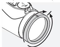
D'abord, tournez la bague d'ajustement dioptrique entièrement vers la gauche (sens inverse des aiguilles d'une montre), puis vers la droite, jusqu'à ce que la mise au point du réticule soit
