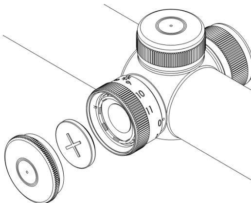
Abb. 5: Batteriewechsel
