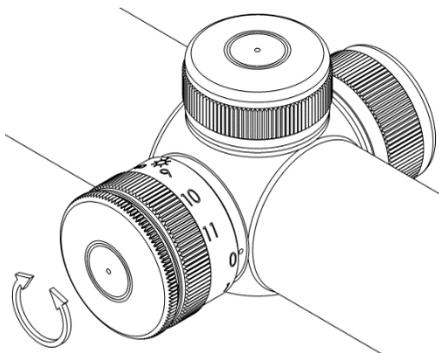
Abb. 4: Bedienen der Beleuchtung
