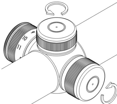
Abb. 7: Entfernen der Kappen von Höhen- und Seitenturm
