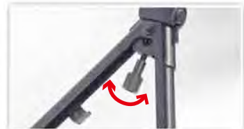
Tournez la molette dans le sens antihoraire pour surélever le bipied. Tournez dans le sens horaire pour abaisser.
